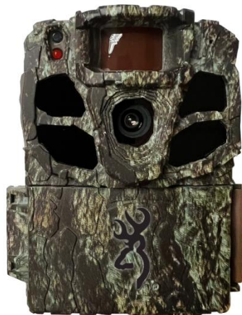
Figura 4. Model cameră automată cu senzor de mișcare utilizată în acest studiu (Browning Dark Ops)
